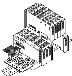
Auch die Ansteuerung der Heizleitungen ist direkt in das Raychem NGC-30-System integriert. Hierzu dienen die externen Beheizungs-Steuerungsmodul (RMC), mit denen sich die Leistungsschütze der einzelnen Heizkreise ansteuern lassen. Das Beheizungs-Überwachungsmodul RMM übermittelt Pt 100-Temperatursignale aus dem Beheizungssystem. Über das Bedienterminal UIT erfolgt dann die Temperaturregelung.
