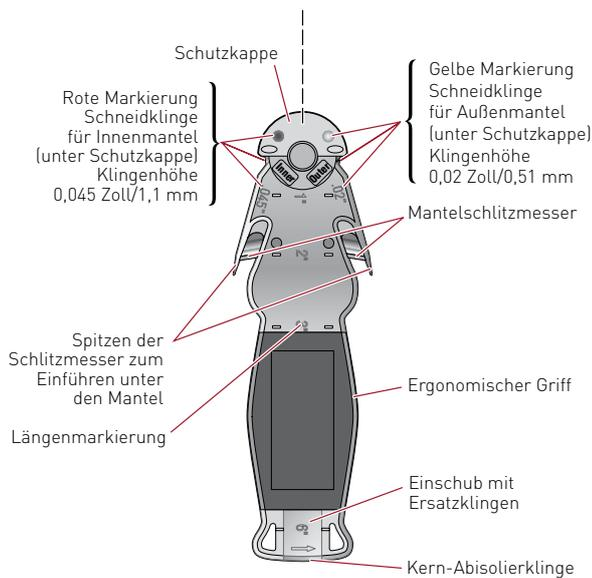
Das Abisolierwerkzeug STRIPPING-TOOL-SR-CABLE ist für die Verwendung mit den selbstregelnden Heizbandtypen Raychem BTV-CR, BTV-CT, QTVR-CT, XTV-CT, KTV-CT, HWAT, XL-Trace, IceStop und RaySol geeignet. Mit dem Werkzeug lassen sich die Heizbänder schneller, sicherer und zuverlässiger konfektionieren.
